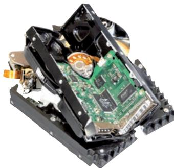
La trituradora retuerce las unidades de disco duro. La solución ideal, cuando se trata de requerimientos de alta seguridad, es combinarla con un desmagnetizador. Nivel de seguridad H3\* para uso autónomo.
